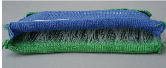
Şekil 2. Monofilament bağlantılı 3 boyutlu kumaş (Ünal, 2014)
